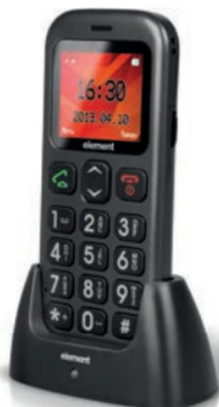
Pro snadnou práci s telefonem je připraven stolní stojánek. Do něj lze telefon odkládat se současným nabíjením baterie telefonu. V tom případě dodanou nabíječku nepřipojujte přímo do telefonu, ale zapojte ji zezadu do stojánku. Přitom se zeleně rozsvítí kontrolka zepředu stojánku. Při každém vložení telefonu se jeho baterie nabíjí, nabíjení signalizuje přední kontrolka červenou barvou a pomalým blikáním.
