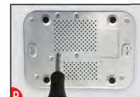
Pomocou skrutiek uchyťte disk HDD zo spodnej strany rekordéru. Nasuňte horný kryt a upevnite skrutky.
