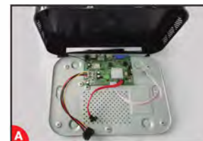
Odcłóż urządzenie NVR od zasilania, odkręć i usuń górną obudowę.
