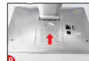
Trzymając dysk twardego i NVR, delikatnie go obróć, wyrównaj otwory na dysku twardego z otworami na NVR. Załóż pokrywę.
