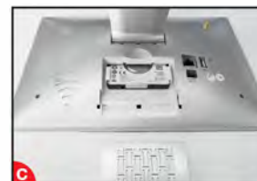
Umístěte disk HDD do rekordéru dle ploch pro uchycení.
