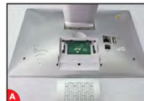
Odpojte NVR od napájania, a zložte horný kryt.
