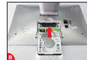
Podłącz z urządzenia NVR do odpowiednich portów na dysku twardego (jak pokazano).
