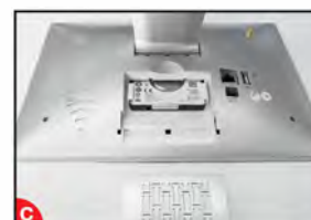
Umiestnite disk HDD do rekordéru podľa plôch pre uchytienie.
