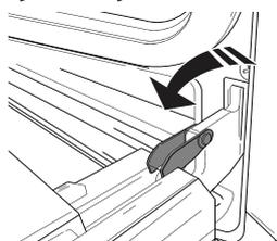
2. Dvířka dobře uzavřete. Pevně je držte oběma rukama – nedržte je za rukojeť. Dvířka snadno vysadíte tak, že je budete nepřetržitě zavírat a současně za ně táhnout (a), dokud se neuvolní z usazení (b).
